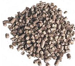
Топливо не должно содержать камней, кусков дерева и других загрязнений. При ручной загрузке используются дрова лиственных пород (с влажностью 20%) и уголь любой фракции.
