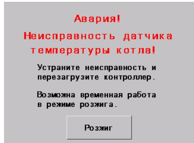
Данная ошибка появляется при неисправности датчика температуры теплоносителя.
