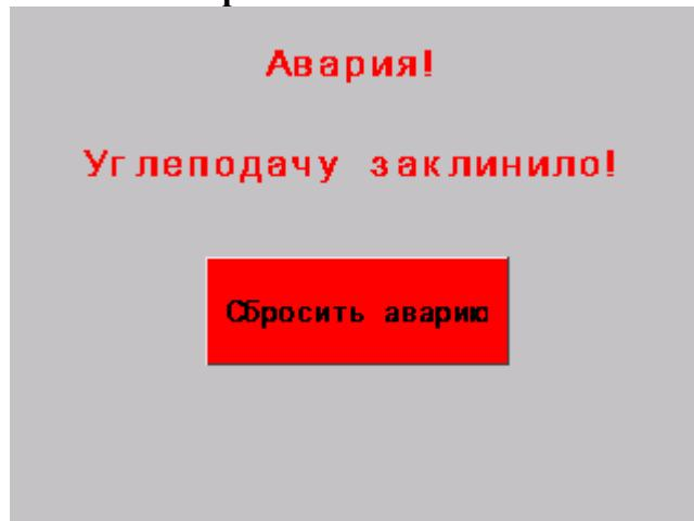
Данная ошибка появляется на экране контроллера после 7-ми попыток автоматического реверса шнека (поршня). Необходимо нажать «Сбросить аварию» затем в меню «Настройка розжига, управление углеподачей» произвести несколько попыток «Реверс».
