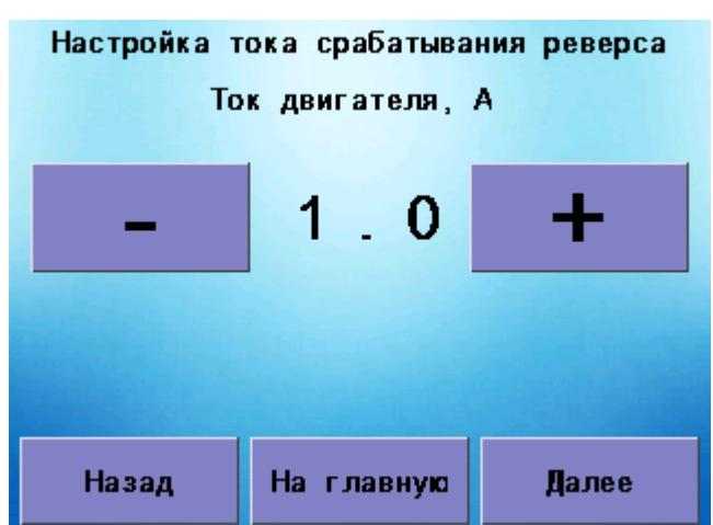
В данном меню производится установка порогового значения тока двигателя привода шнека (поршня), при котором происходит реверс направления вращения шнека (поршня) для устранения заклинивания в случае попадания в топливо кусков породы и т.п.
